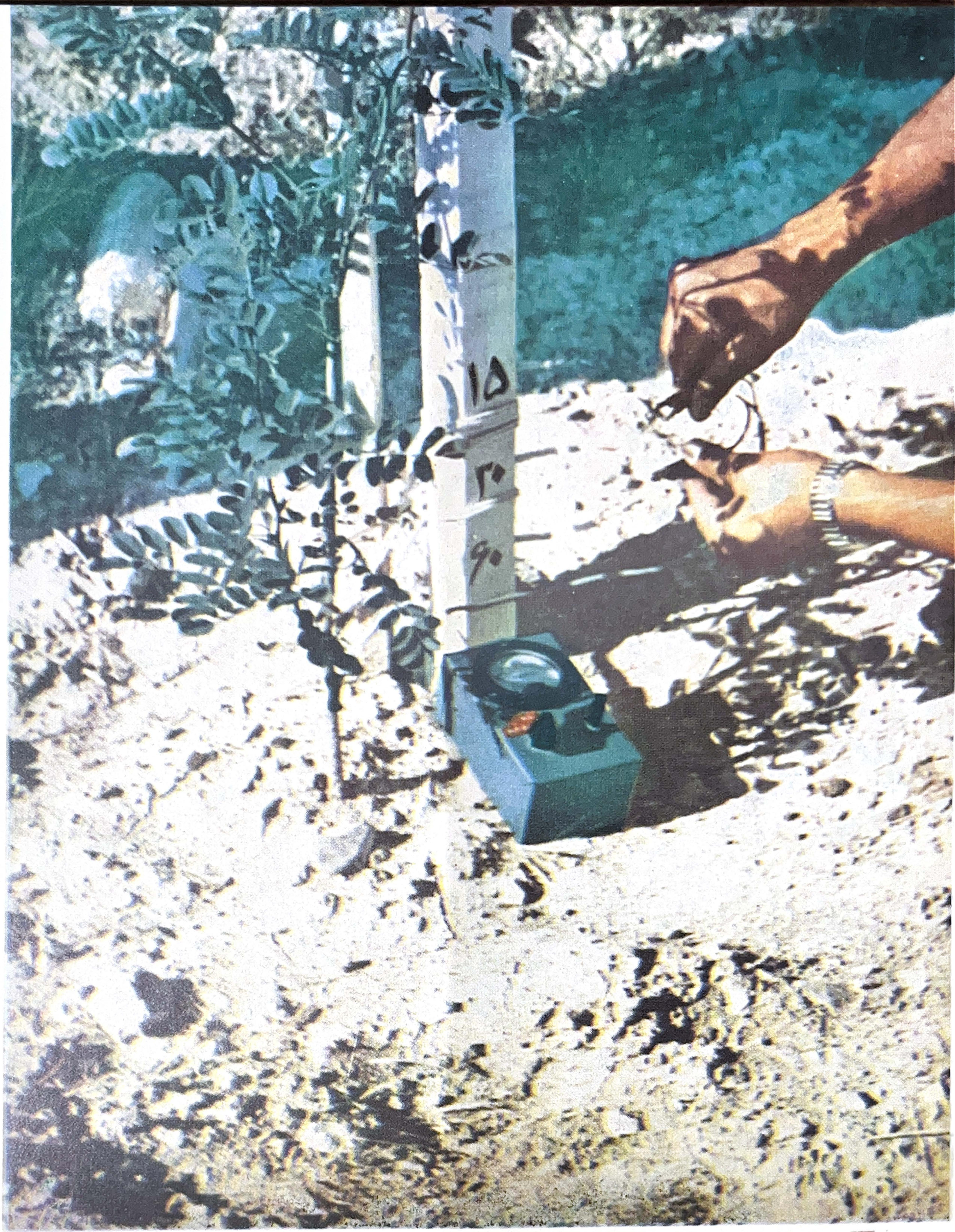
تصویر ۲ - آمار هفتگی رطوبت خاک در سه عمق ۱۵، ۳۰ و ۶۰ سانتی‌متر با استفاده از بلوک‌های گچی تهیه شد. این بلوکها و همچنین دستگاه اندازه‌گیری شدت جریان در آنها در آزمایشگاه خاک مؤسسه تحقیقات چنگلها و مراتع در تهران تهیه شده است.
